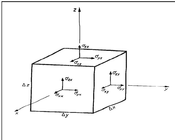
Wären die Schubspannungen in zueinander senkrecht stehenden Schnitten nicht gleich groß, so würde ein resultierendes Drehmoment am Volumenelement angreifen, also sind nur 6 Komponenten des Tensors voneinander unabhängig:
